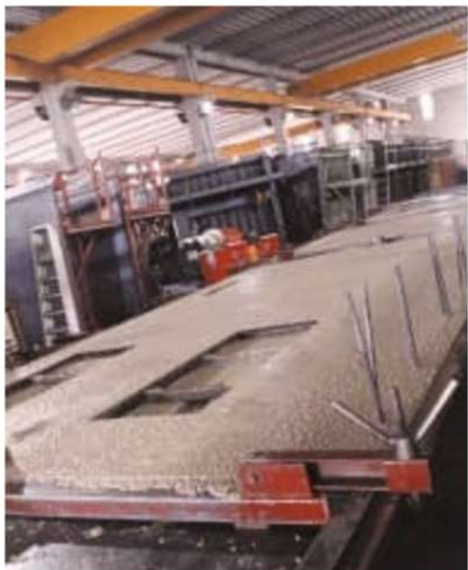
Processo di fabbricazione della struttura in cemento armato vibrato.
