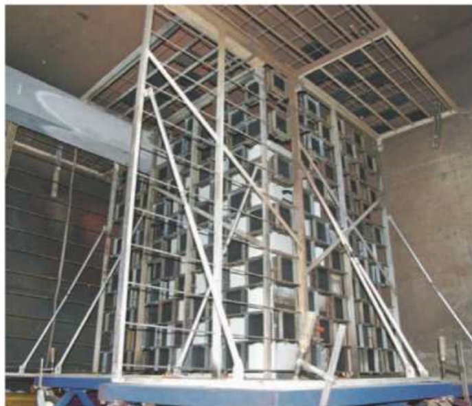
Struttura per una prova di tenuta all'arco interno Setup for an internal arc withstand test
